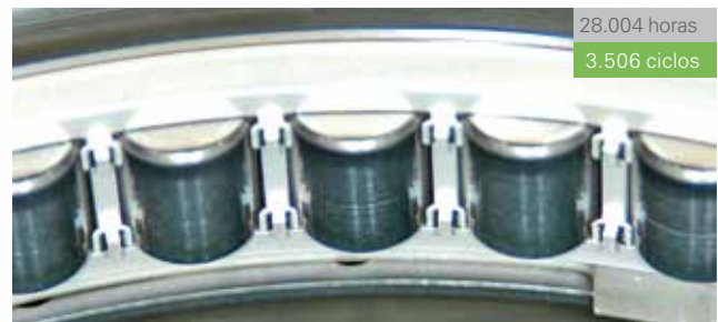
CF6-80C2, mancal nº 6 no reservatório D
