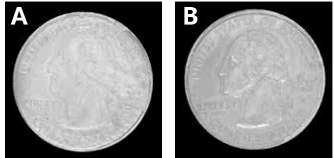
A = 基于TDI封端的聚酯预聚物/芳族二胺体系的标准配方 B = 添加5%伊士曼TXIB配方添加剂的相同配方
