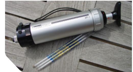
Dependiendo de las instrucciones de los fabricantes, determinado volumen de aire ambiente se bombea a través de un tubo de reacción al gas de vidrio sellado después de la desconexión de las boquillas de admisión y de escape (lado de la bomba). El gas reacciona con un agente colorante que se absorbe en material de soporte. Las lecturas se toman de la decoloración de la zona en una escala numérica de concentración de MITC.
