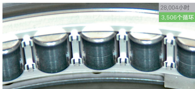
CF6-80C2, 干式油底壳中的6号轴承
