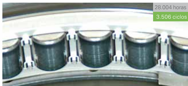
CF6-80C2, mancal nº 6 no reservatório D
