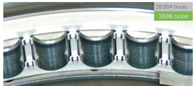
CF6-80C2, rodamiento n.º 6 en depósito D
