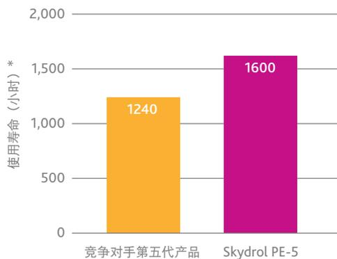
\*在257°F (125°C) 和0.5% H<sub>2</sub>O的实验室条件下进行液压油测试
