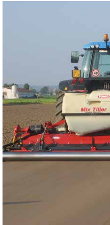
Rolos de compactação de solo em máquinas IMANTS (esquerda) e em uma máquina FORIGO (direita)
