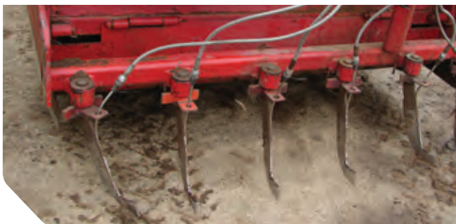
Des coutres peu profonds pour une utilisation sous serre
