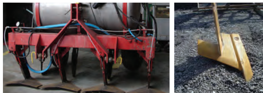
Les différentes sortes de systèmes d'injection à soc en patte d'oie
