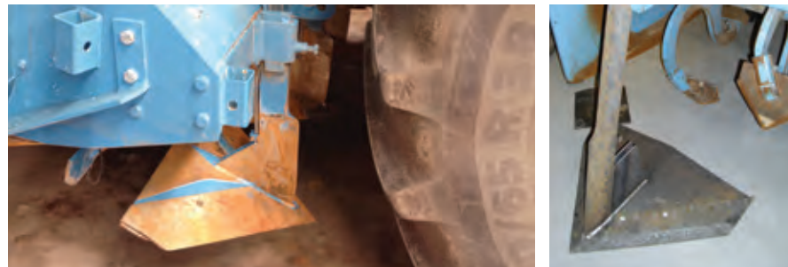
Les différentes sortes de systèmes d'injection à soc en patte d'oie
