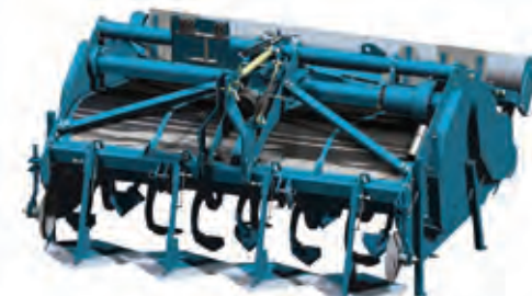
● Máquina de pá giratória com injeção (fabricada pela Imants)
