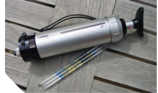
A seconda delle istruzioni del produttore, un volume di aria ambiente viene pompata attraverso un tubo di reazione al gas di vetro sigillato dopo che le punte di ingresso (lato della pompa) e scarico sono interrotte. Il gas reagisce con un agente colorante assorbito un materiale carrier. Le letture vengono effettuate nella zona scolorita su una scala di concentrazione numerica del MITC.
