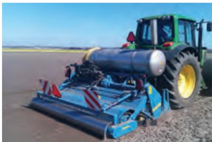
Serbatoio montato posteriormente
