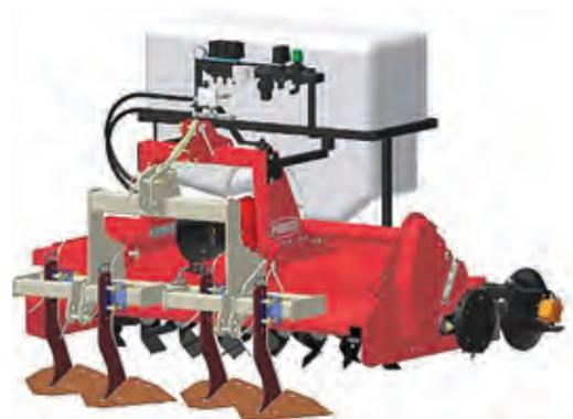
Macchina di disinfezione del terreno Mix Tiller Deeper (prodotta da FORIGO)
