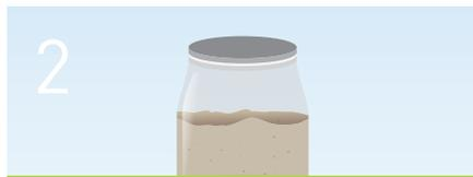
2 Rimuovere da 2 a 4 (25-50 g) piccoli campioni di terreno, miscelare leggermente e collocare immediatamente una porzione in un vasetto a tenuta d'aria affinché i fumi non fuoriescano. Utilizzare vasetti di vetro con coperchi a tenuta di gas.
