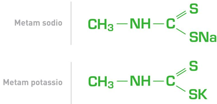
Applicati al terreno essi iniziano a decomporsi in metilisotiocianato (MITC), bisolfuro di carbonio, solfuro di idrogeno e altri composti a seconda del pH del terreno.
