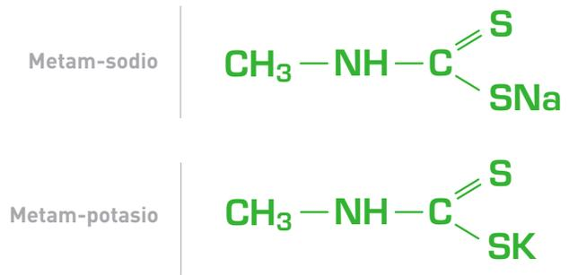
Aplicado al suelo, inicia su descomposición en metil isotiocianato (MITC), disulfuro de carbono, sulfuro de hidrógeno y otros en función del pH del suelo.
