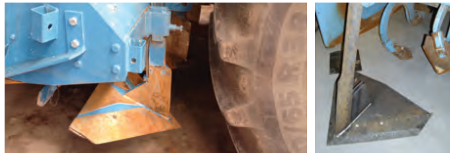
Διάφοροι τύποι συστήματος έγχυσης με υνί
