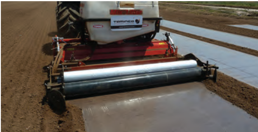
Εξοπλισμός ενός περάσματος: μηχάνημα εφαρμογής/ενσωμάτωσης/σφράγισης πλαστικής μεμβράνης
