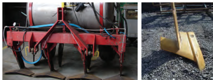
Διάφοροι τύποι συστήματος έγχυσης με υνί
