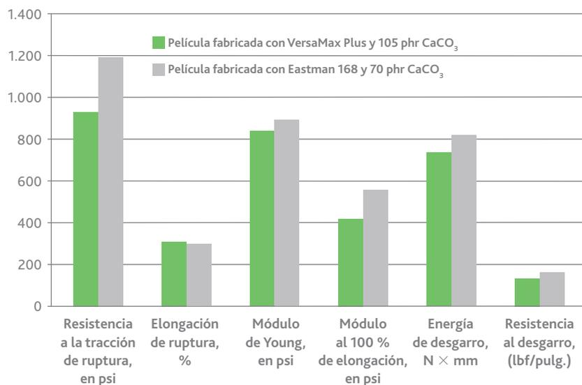
Debido a su mayor eficiencia, la formulación de VersaMax Plus puede utilizar el 50% más de carga, a la vez que logra la misma dureza y propiedades mecánicas similares.
