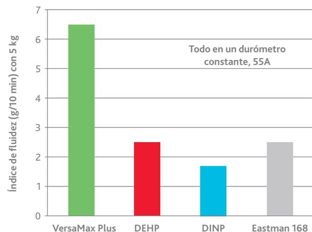
Con el uso de un plastómetro, se midieron los índices del flujo de fusión de los compuestos con distintos plastificantes. Cuanto más alto era el índice de flujo de fusión, menor era la viscosidad de fusión del compuesto. VersaMax Plus demuestra la mayor viscosidad de fusión.
