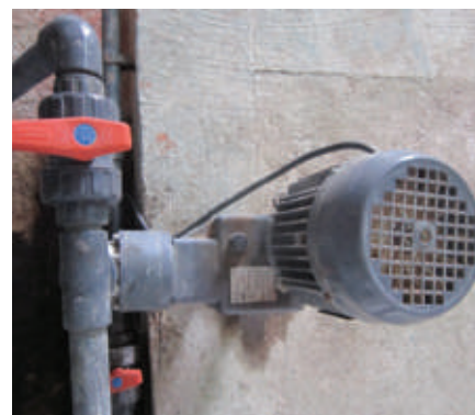
Une méthode plus courante consiste à connecter une pompe doseuse directement au fût de metam
