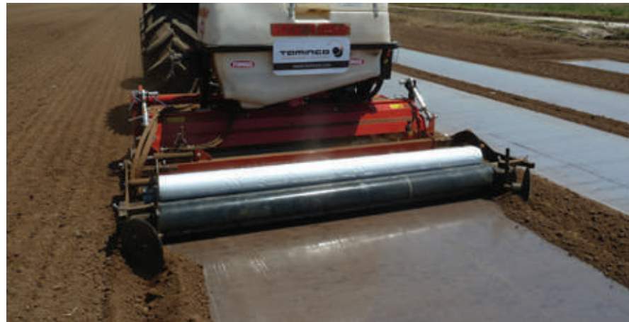
Εξοπλισμός ενός περάσματος: μηχάνημα εφαρμογής/ενσωμάτωσης/σφράγισης πλαστικής μεμβράνης
