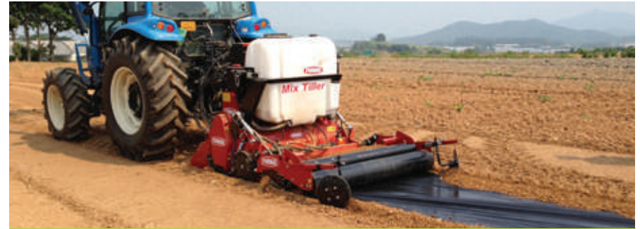
Εξοπλισμός ενός περάσματος: μηχάνημα εφαρμογής/ενσωμάτωσης/σφράγισης πλαστικής μεμβράνης
