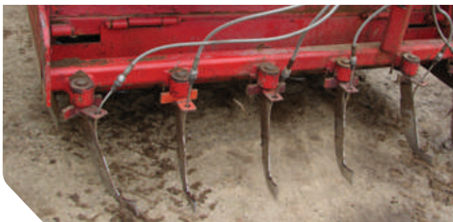
Ρηκά στελέχη για χρήση σε θερμοκήπιο
