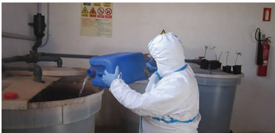
O metam é introduzido no cabeçote do sistema de irrigação, despejando o produto no tanque disponibilizado para este fim (não é um método tão comum)
