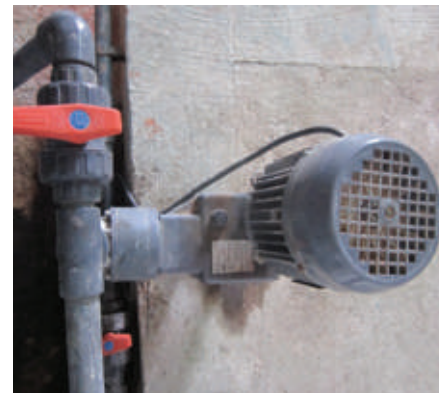
Por otra parte, la bomba se puede conectar directamente al tambor que contiene metam (metodo mas común)
