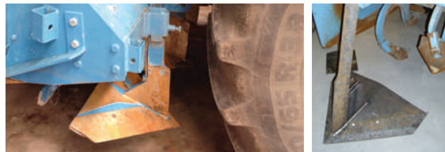
Diversos tipos de sistema de inyección con reja pata de ganso
