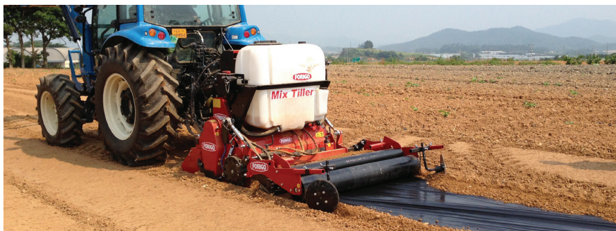
Apparecchiatura a passaggio singolo: macchina di applicazione/incorporazione/sigillatura del film plastico
