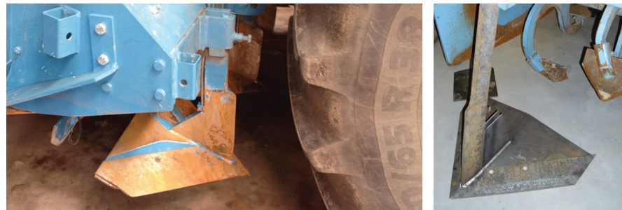
Diversi tipi di sistemi di iniezione con lame a zampa d'oca
