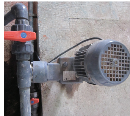
In alternativa, una pompa può essere collegata direttamente al serbatoio contenente metam (soluzione più praticata)
