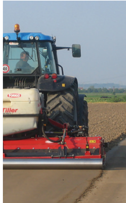
Ρολά συμπύκνωσης εδάφους σε μηχάνημα IMANTS (αριστερά) και σε μηχανήμα FORIGO (δεξιά)
