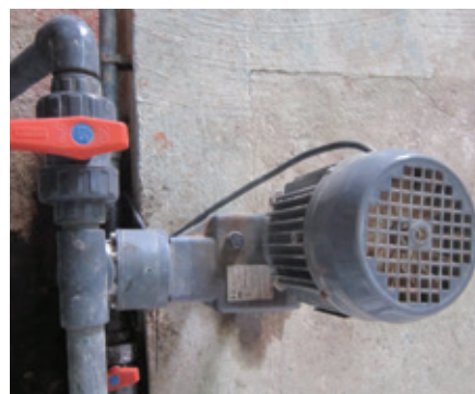
Η αντλία για την έγχυση του metam από τη δεξαμενή στον σωλήνα νερού της άρδευσης λειτουργεί με ηλεκτρισμό.
