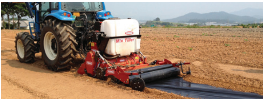
Apparatuur voor één werkgang: machine voor toepassen/inwerken en afsluiten met plastic folie
