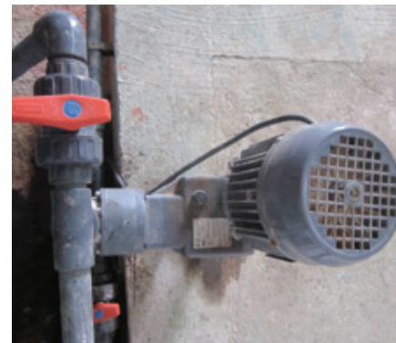
Een pomp kan ook rechtstreeks op het vat met metam worden aangesloten (meest gebruikelijke methode)
