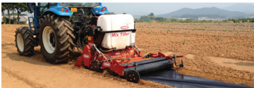
Equipement en un seul passage : machine qui applique, incorpore et pose le film plastique
