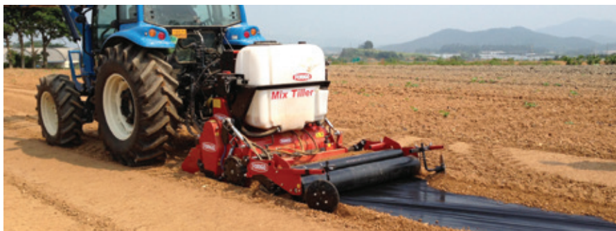
Equipamento de passe único para aplicação/incorporação/selagem do filme plástico
