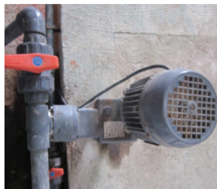
Alternativamente, uma bomba pode ser conectada diretamente ao tambor contendo metam (método mais comum)
