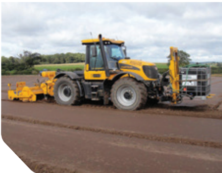
Rolo compactador del suelo en una máquina Imants (izquierda) y en una máquina Forigo (derecha)
