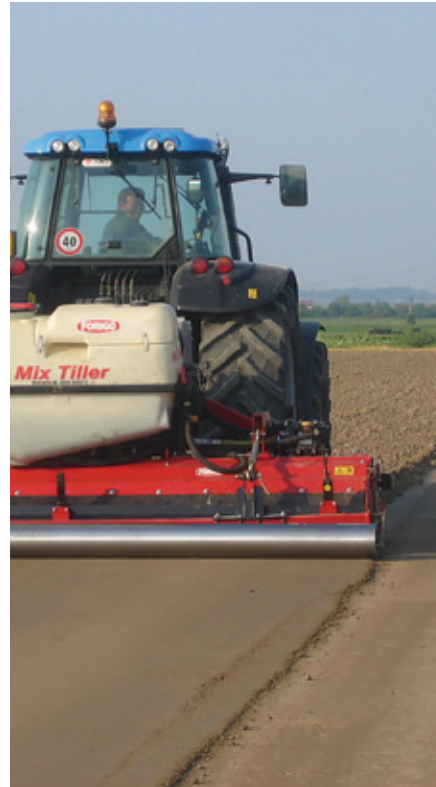
Rolo compactador del suelo en una máquina Imants (izquierda) y en una máquina Forigo (derecha)
